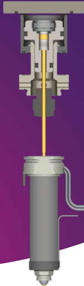
**Das MVG25 (Manifold Valve Gate) System ist ideal für kleine bis mittelgroße Anwendungen, die enge Kavitäten, eine schnelle, sequentielle Befüllung oder hochpräzise Anspritzverschlüsse erfordern.**
