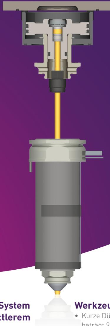
**Das MVG55 (Manifold Valve Gate) System ist ideal für Anwendungen mit mittlerem bis großem Schussgewicht, die eine sequentielle Befüllung oder hochpräzise Anspritzverschlüsse erfordern.**
