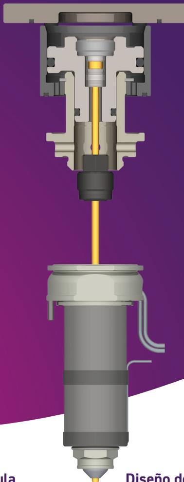
**El sistema MVG40 (entrada de válvula distribuidora) es perfecto para todas las aplicaciones que requieran un llenado preciso, rápido y secuencial o entradas con acabados muy superficiales.**
