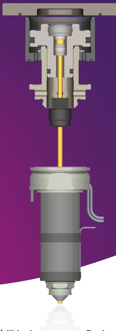
**Il sistema di otturazione MVG40 è l'ideale tutte le applicazioni che richiedono cicli veloci, iniezione sequenziale o qualità estetica elevata.**
