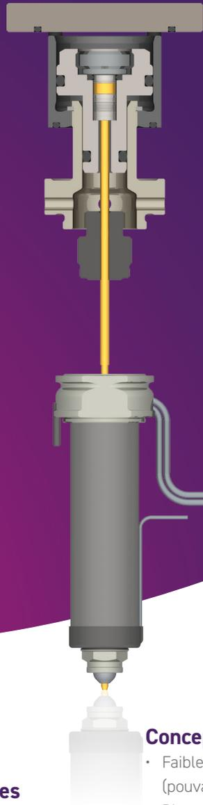
**Le système MVG25 (Obturation à pneumatique) est idéal pour les petites et moyennes applications nécessitant des encombrements réduits, une grande vitesse, un remplissage séquentiel ou des seuils cosmétiques.**
