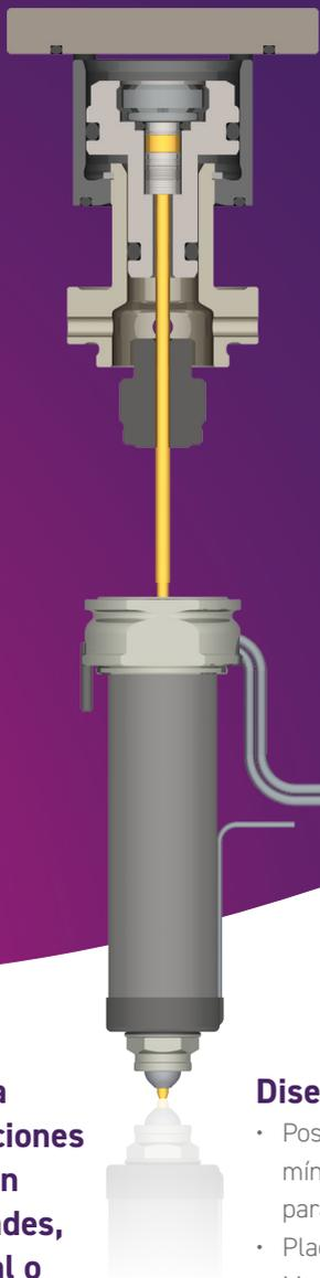
**El sistema MVG25 (entrada de válvula distribuidora) es perfecto para aplicaciones de pequeñas a medianas que requieran una separación estrecha en las cavidades, un llenado rápido, preciso y secuencial o entradas con acabados muy superficiales.**
