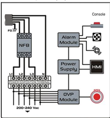
System Wiring Diagram
